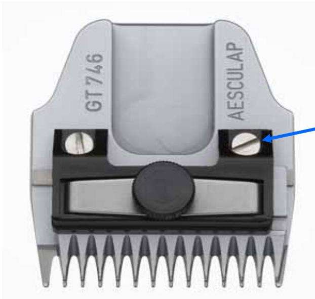
Vérifier si il n'y a pas de fissures ou d'usure au niveau de l'élément de pression. Sinon la plaque supérieure ne peut pas être conduite correctement et entraîne un mauvais résultat de coupe.
