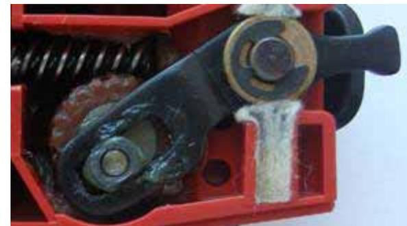
Un levier oscillant usé ne transmet plus complètement la force et ne pousse plus suffisamment en va et vient la plaque supérieure de la tête de coupe.
